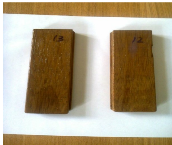
Рис. 10. Древесина дуба с узкими годовичными слоями
