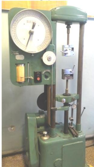
Рис. 1. Разрывная машина МР-0,5
