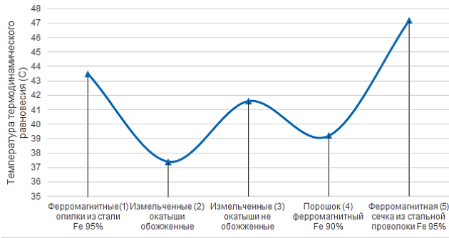
Рис. 3. Индукционный нагрев ферромагнитных наполнителей током частотой 7 кГц
