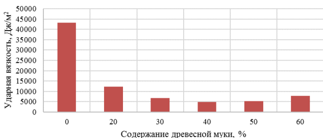
Рис. 10. Влияние состава композита на ударную вязкость образцов
