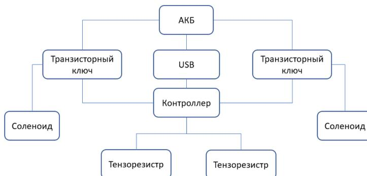
**Рис. 8.** Принципиальная электрическая схема мехатронного переходника
