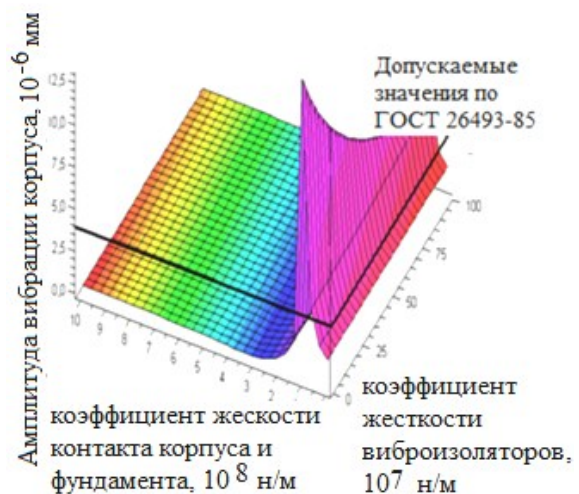
Рис. 5. Амплитуда вибрации корпуса мельницы TF-52 в зависимости от коэффициентов жесткости динамической системы
