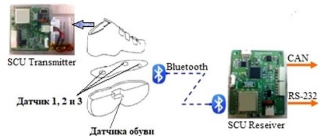
**Рис. 3.** Компоненты датчика обуви
