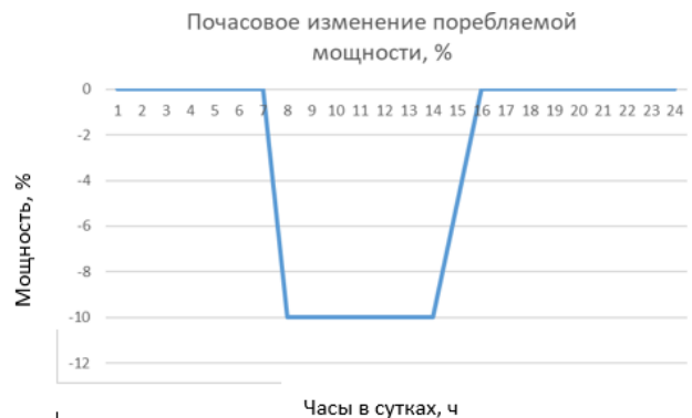
Рис. 2. Почасовое изменение потребляемой мощности на электролизерах ВТ-120 в ремонтном периоде
