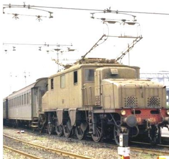
Рис. 1. Схема (а) и фото (б) трехфазной тяговой сети
