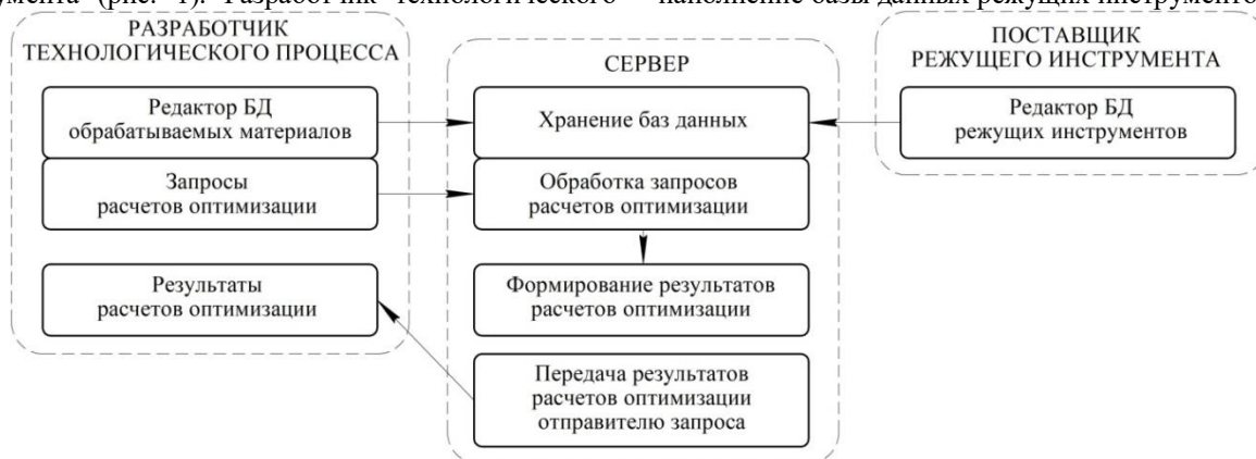
Рис. 1. Схема обмена данными в САПР
