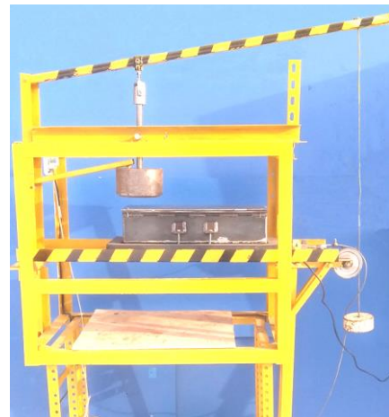
Рис. 3. Лабораторная установка — сдвиговой стенд
