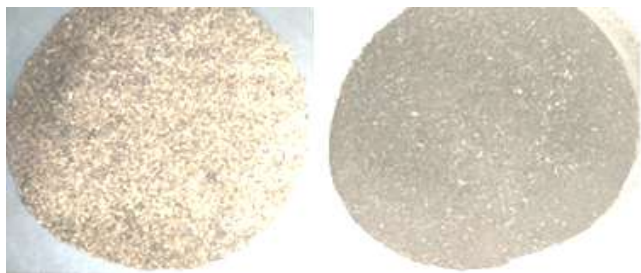
Рис. 5. Отходы древесного сырья до и после торрефикации
