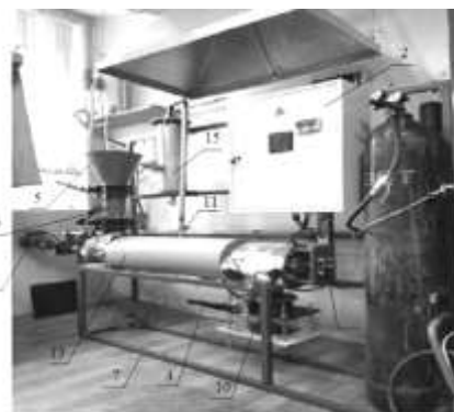
Рис. 4. Установка для исследования процесса торрефикации: 1 - реактор; 2 - шкаф электрический; 3 - баллон с азотом; 4 - заглушка поворотная; 5 - бункер для подачи сырья; 6 - линия подачи сырья; 7 - рама; 8 - мотор-редуктор; 9 - муфта; 10 - бункер выгрузки сырья; 11 - термопара; 12 - патрубок для подвода азота; 13 - кожух; 14 - нагреватель; 15 - гидрозатвор
