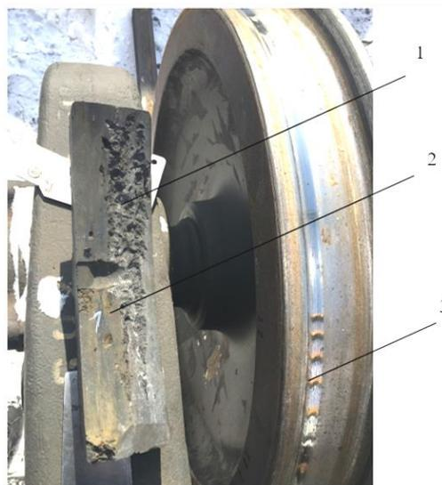
Рис. 1. Интенсивный износ поверхности катания (3) в результате взаимодействия с полимерной колодкой, в которой зафиксированы металлические включения (2) и пористость (1)
