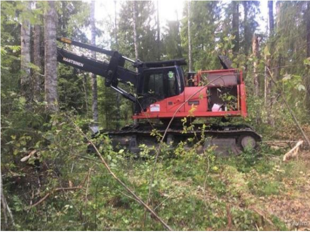
Рис. 2. Реконструированный в валочно-сучкорезно-раскря-жевочную машину (харвестер) погрузчик экскаваторного типа с гусеничным двигателем Mantsinen 60 при заготовке древесины на предприятии ООО «Биенстар»
