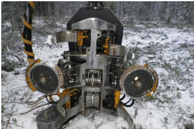
Рис. 3. Харвестерная головка Ponsse H73E, установленная на реконструированной машине Mantsinen 60 на предприятии ООО «Биенстар»
