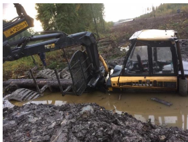
Рис. 1. Результат нерациональной прокладки волоков на лесосеке при заготовке древесины в ООО «Биенестар» (Кингисеппский район Ленинградской области)
