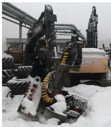
Рис. 1. ВСРМ VolvoEC210Bf на гусеничном ходу на базе экскаватора с харвестерной головкой LogMax6000В
