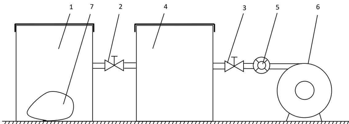
**Рис. 1.** Схема лабораторной установки: 1 – емкость для проб, 2,3 – вентили, 4 – измерительная емкость, 5 – счетчик расхода воздуха, 6 – пневмонасос, 7 – исследуемый образец
