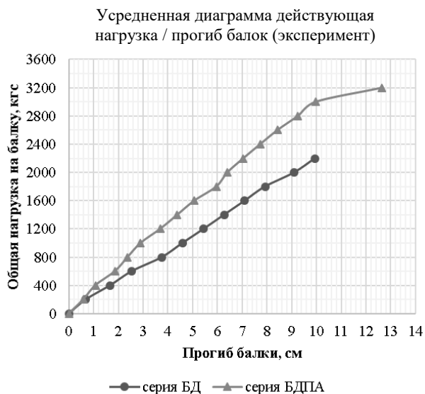
Рис. 10. Диаграмма сравнения прогибов исследуемых балок
