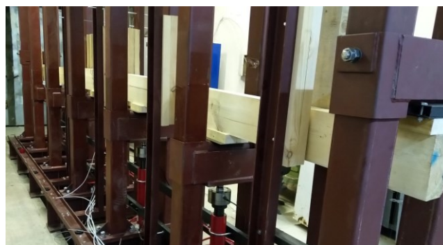
Рис. 7. Прогиб балки серии БД в процессе испытаний
