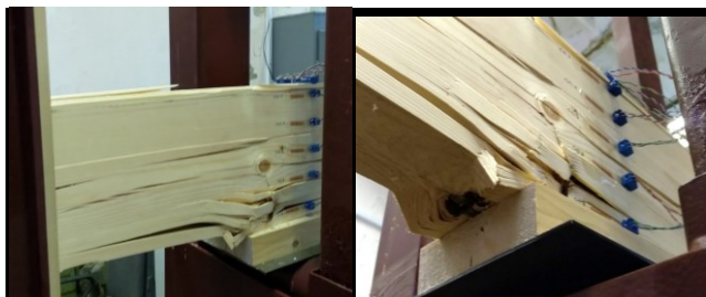
Рис. 9. Разрушение сжатой зоны балки серии БДПА с образованием пластического шарнира
