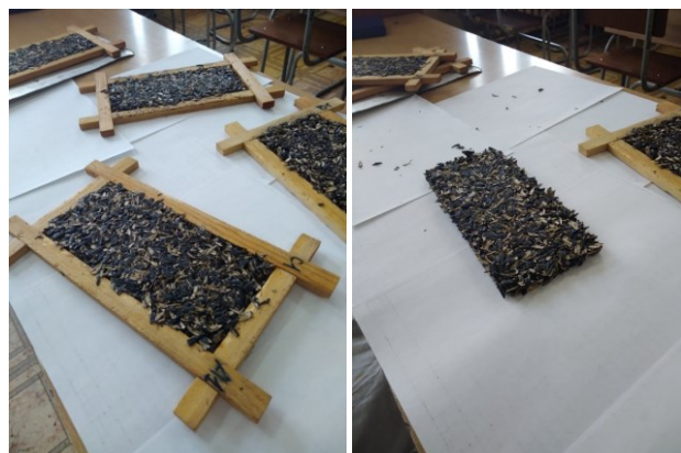
Рис. 1. Фотографии образцов плитных материалов, полученных методом горячего прессования, на основе лузги подсолнечника
