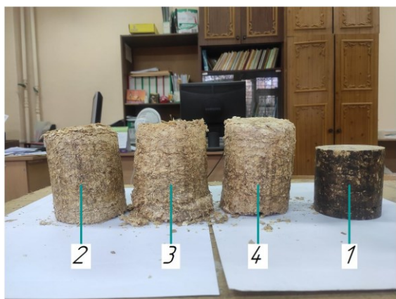
Рис. 10. Изменение высоты брикетов при хранении: 1 — 5 мин; 2 — 0,5 ч; 3 — 2 ч; 4 — 24 ч. Брикеты получены при влажности 10 %, температуре 80 °С, времени выдержки в матрице 12 мин
