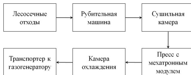
Рис. 1. Схема получения топливных брикетов
