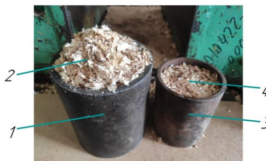
Рис. 7. Прессующий конус и матрица с древесиной: 1 — конус; 2 — щепка; 3 — матрица; 4 — прессованный брикет
