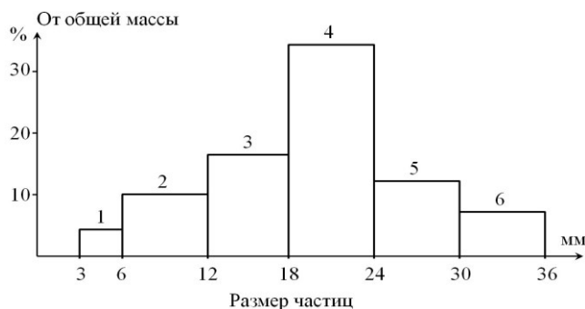
Рис. 9. Фракционный состав щепы по длине частиц: 1 — опилки; 2 — стружка; 3 — мелкая щепа; 4 — кондиционная щепа; 5, 6 — крупная щепа
