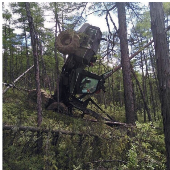
Рис. 1. Результат нерационального отвода деревьев в рубку при выборочных рубках — поломка лесозаготовительной техники
