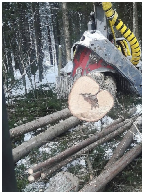
Рис. 2. Результат нерационального отвода деревьев в рубку при выборочных рубках — снижение выхода деловой древесины из-за фаутовых перестойных деревьев
