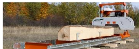
Рис. 2. Ленточная пиломама «Logosol ML-26» для производства пиломатериалов на погрузочном пункте [5]
