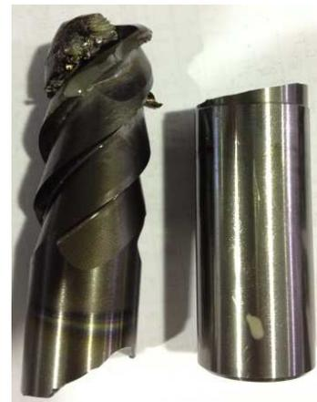
Рис. 2. Разрушение фрезы СКИФ 209
