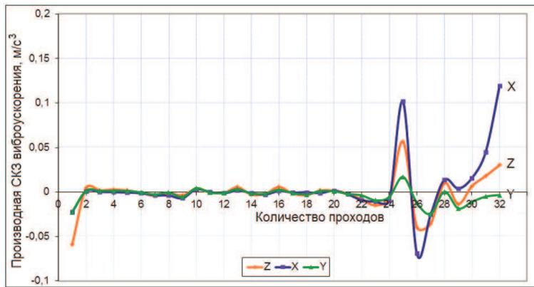
Рис. 8. График производной СКЗ виброускорения фрезы СКИФ 209
