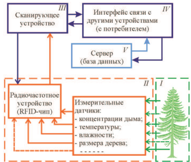
Рис. 2. Реализация системы для сбора данных о лесном фонде на базе радиочастотного мониторинга: I — объект; II — радиочастотное устройство; III — сканирующее устройство; IV — интерфейс связи; V — сервер
