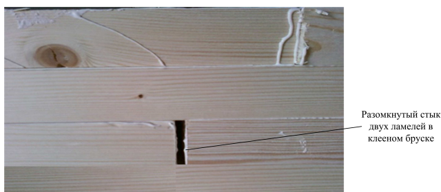
Рис. 1. Пример нарушения технологии сборки ламелей клееного бруска
