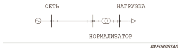
Рис. 7. Устройство системы с нормализатором в программном комплексе Eurostag
