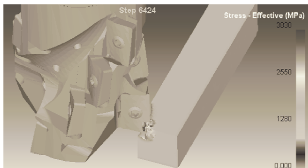
Рис. 2. Моделирование процесса фрезерования
