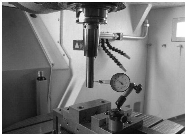
Рис. 2. Измерение радиального биения термоусадочного патрона Haimer A63.140.16
