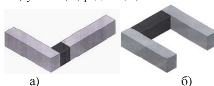
Рис. 3. Варианты пространственных решений «зависимых» вставок: а) Г-образная; б) П-образная
