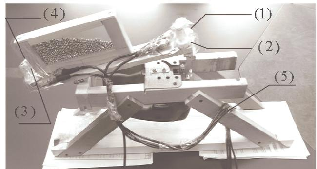
**Рис. 4.** Макет вибростенда для возбуждения гранулированной среды в контейнере
