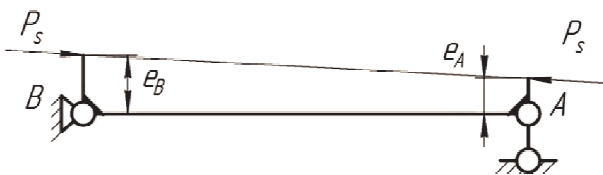
Рис. 2. Расчетная схема эксцентричного нагружения гидроцилиндра продольным сжимающим усилием P_s
