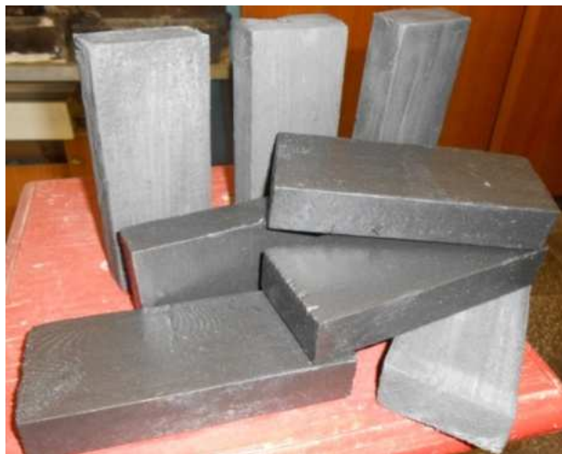
Рис. 1 Деревянные образцы, покрытые огнезащитным составом в 3 слоя (перед испытанием)
