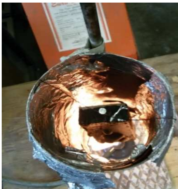
Рис. 2. Огневые испытания исследуемых материалов
