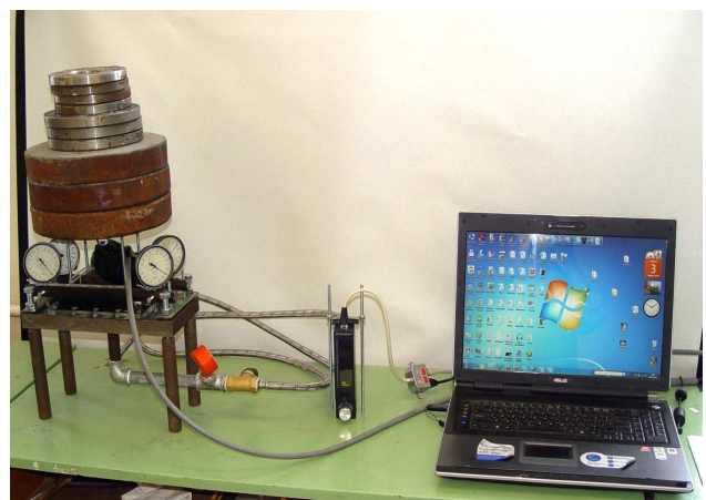
Рис. 1. Общий вид стенда для исследований плоских аэростатических опор
