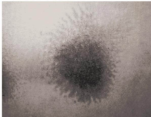
Рис. 2. Дендритные образования на поверхности диэлектрического материала
