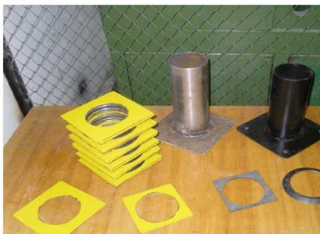
**Рис. 3.** Виброактиватор наборного типа
