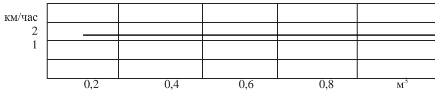
Рис. 9. График зависимости технологической скорости производства хлыстов от объема для комплекса «валочно-пакетирующая машина ЛП-19 с харвестерным ЗСУ – трелевочный трактор ТБ-1М – челюстной погрузчик ЛТ-65Б»
