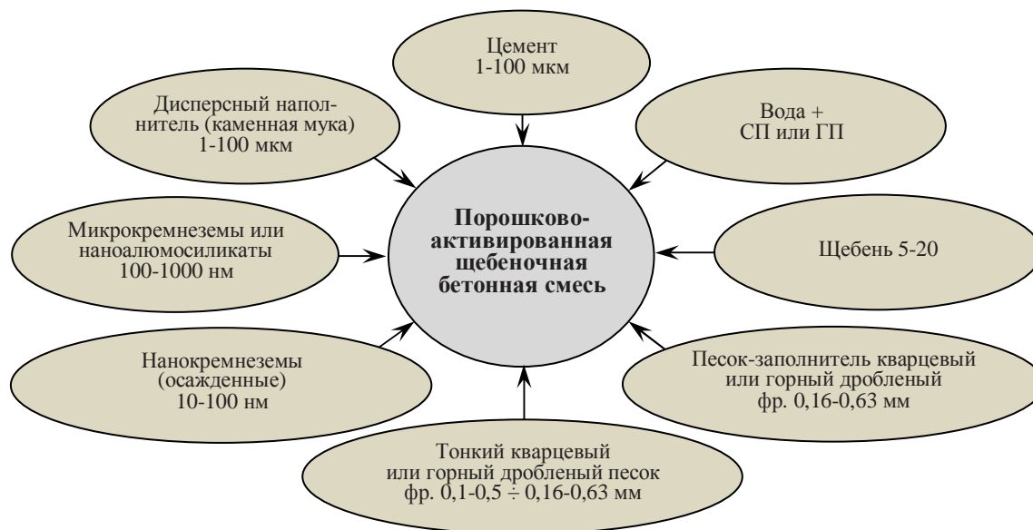
Рис. 1. Компоненты порошково-активированных щебеночных бетонов нового поколения с микро- и наномасштабными наполнителями
