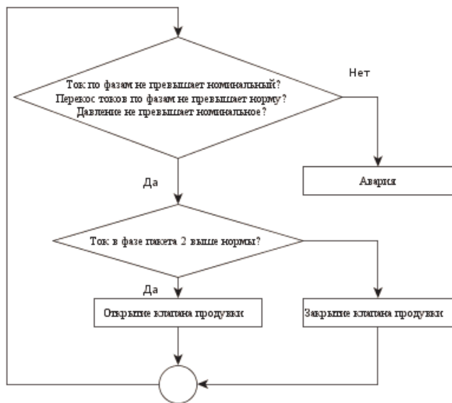
Рис. 4. Алгоритм защиты по току и давлению и управления клапаном продувки
