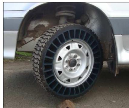
Рис. 4. Автомобильное колесо с безвоздушной шиной
