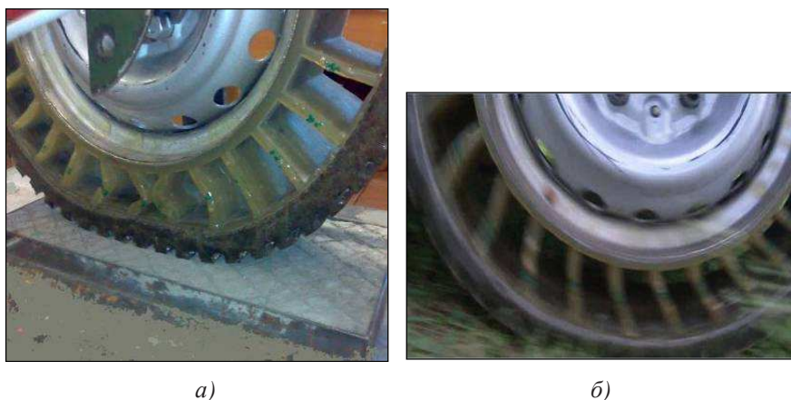
Рис. 1. Экспериментальные образцы колес с безвоздушными шинами: а) – при квазистатическом нагружении на испытательном стенде, образец № 5; б) – в процессе качения в ведущем режиме, образец № 6
