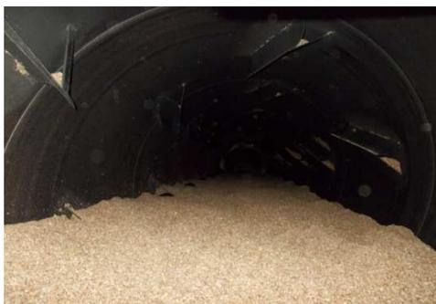
Рис. 3. Внутренняя конструкция барабана
