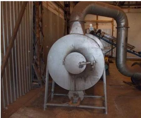
Рис. 6. Устройство выгрузки из сушильного барабана
