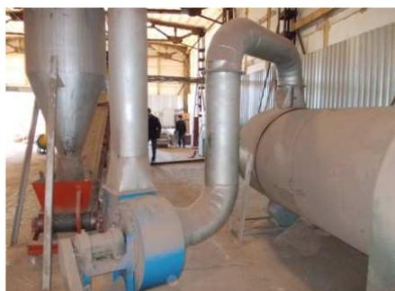
Рис. 5. Газоход соединительный
