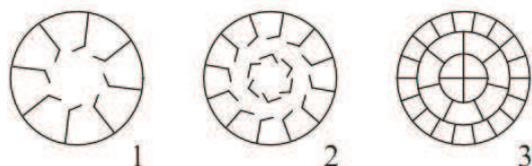
Рис. 4. Внутренние насадки барабанных сушилок
