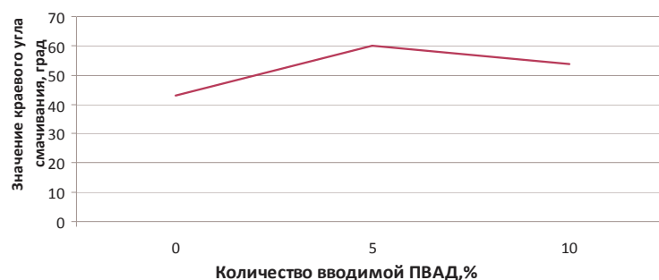
Зависимость краевого угла смачивания от количества вводимой ПВАД
