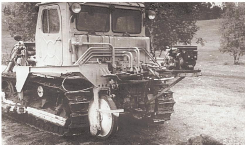
Рис. 1. Экспериментальный бульдозер класса 40 кН с ГМТ.
