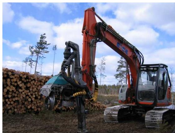
Рис. 3. Харвестер на базе экскаватора *FIAT-Kobelco E135SR* с головкой *Kesla 22RH*.
