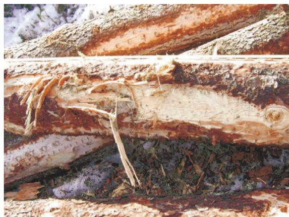
Рис. 9. Повреждения ствола приводными вальцами.
