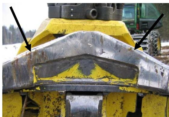
Рис. 5. Нож опорный верхний со встречной заточкой по нижней грани режущей кромки.
