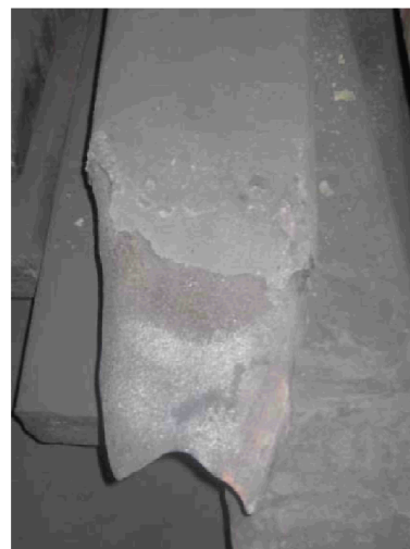
Рис. 2. После взаимодействия с расплавленным алюминием
