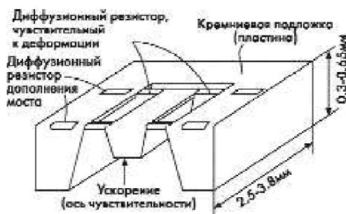
Рис. 2. Интегральный акселерометр объемной конструкции.
