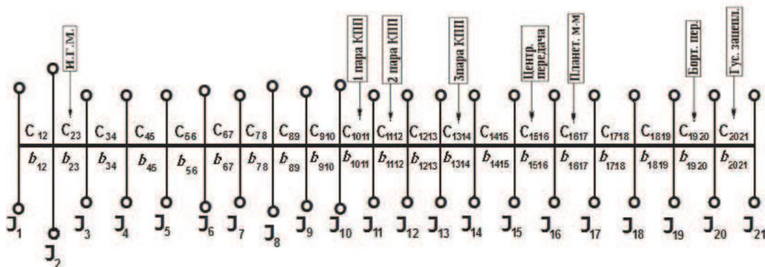
Рис. 1. Расчетная цепная динамическая модель механической трансмиссии экспериментального трактора ТП-4Э для I – IV передач.
