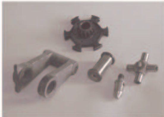
Рис. 2. Детали авиатехники, восстановленные методом порошковой лазерной наплавки.
