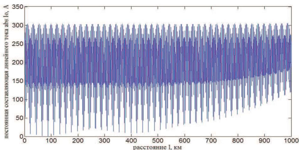
**Рис. 3. Графическая интерпретация распределения постоянной составляющей линейного тока вдоль несимметричного однородного участка трехфазной ЛЭП трехпроводного исполнения протяженностью 1000 км**
