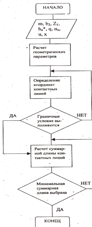
Рис. 3. Структура алгоритма расчета минимальной суммарной длины контактных линий передач с червяками ZA.
