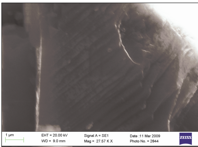
Рис. 2. Дефекты поверхности алмазного зерна, увеличение \times 27570 .
